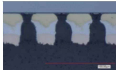
Au-Solder断面写真 bump pitch=50 \mu\text{m} 各種プロセス対応可能
